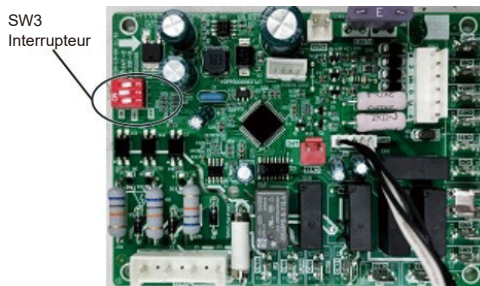
Fig. 7 Emplacement du commutateur SW3 sur la carte de circuits imprimés (à titre de référence seulement)
